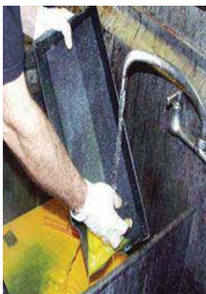
Limpieza de bandeja con recubrimiento
